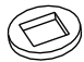
M8 washer rondelle M8 dichtingsring M8 Dichtungsring M8 arandela M8 anilhas M8 (x2) G
