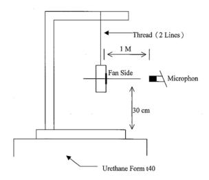
1 METER FROM MICROPHONE TO FAN INTAKE
