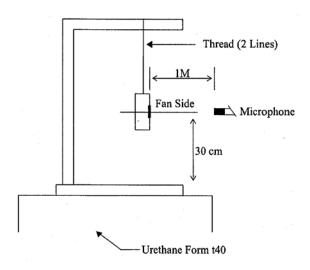
1 METER FROM MICROPHONE TO FAN INTAKE
